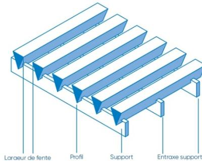
Les profils triangulaires sont soudés sur des supports avec un espacement (fente) souhaité. L'entraxe entre les supports est fixe. Il est un multiple de 25 mm (25, 50, 75, 100 mm...). Son choix est conditionné par des critères esthétiques, mais aussi par des contraintes mécaniques.
